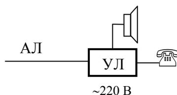
Рисунок 3 - Схема включения блока УЛ
