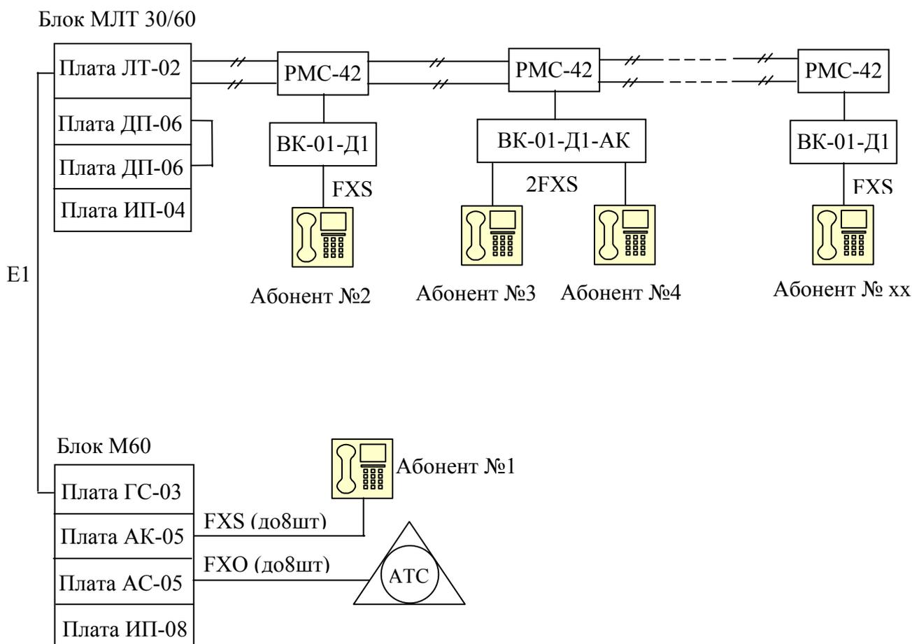
Рисунок 2 – Вариант организации системы диспетчерской связи в линейном тракте с выходом на вышестоящую АТС
