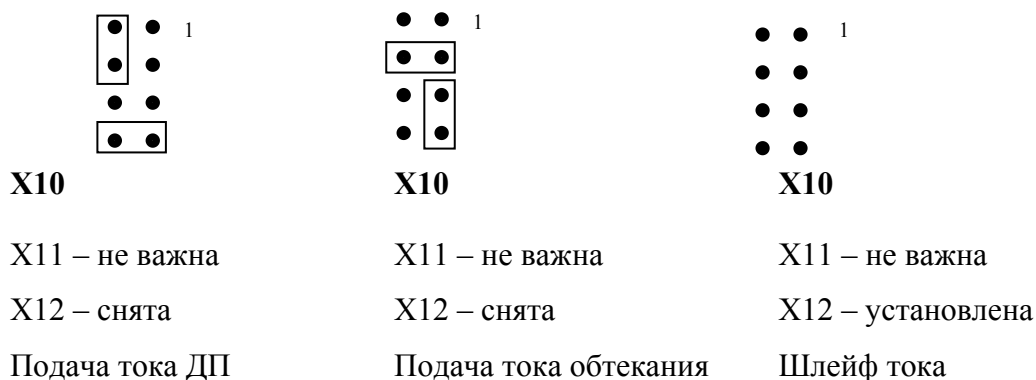
Рисунок 9 - Установка переключателей для однопарного режима работы при установке по одному модему на каждой стороне линейного тракта.
