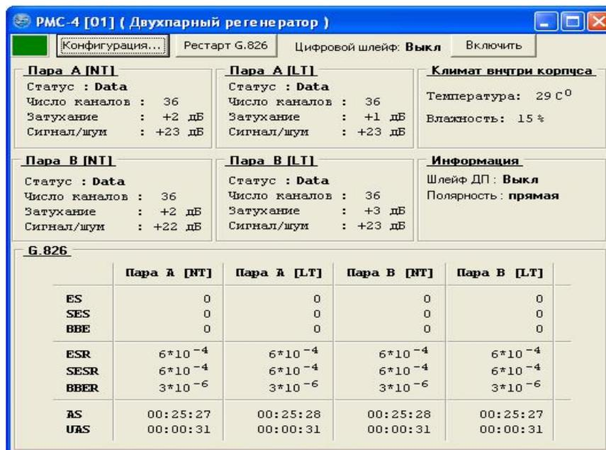
Рис. 18. Окно состояния регенератора.
